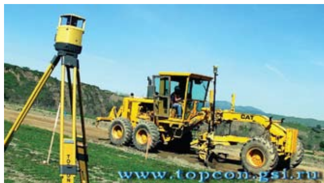
Фото 4. Автогрейдер позиционируется с использованием Topcon mmGPS
