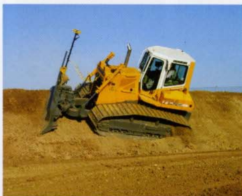
Рис. 3. Пример установки 3D-систем управления Topcon на различной технике
