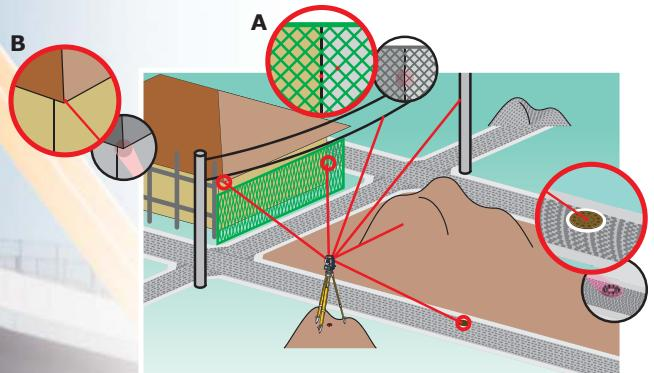
Тончайший луч дальномера позволяет с высокой точностью выполнить измерения на стены и углы зданий, люки на поверхности дороги, сетчатые ограждения, имеющие однородную структуру, и ветки деревьев.
